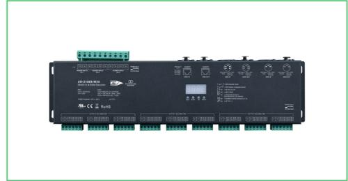
DMX512 LED Controller mit 36 Kanälen à 3A, RDM, 8/16-Bit PWM, 12–24 V. Ideal für professionelle Lichtsteuerung mit exakter Dimmung und Master-/Slave-Betrieb.
